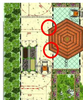
doivent pas être à moins de 1m50 des poteaux de l'équipement. Cela pourrait entraver l'aire de rotation nécessaire à un fauteuil roulant.
