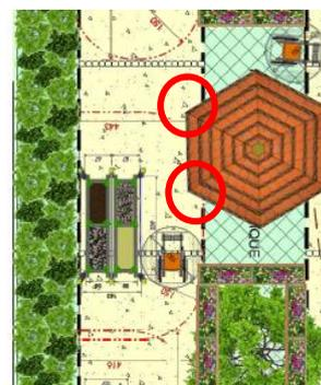
Le kiosque a été agrandi, les poteaux du kiosque ne doivent pas être à moins de 1m50 des poteaux de l'équipement. Cela pourrait entraver l'aire de rotation nécessaire à un fauteuil roulant.
