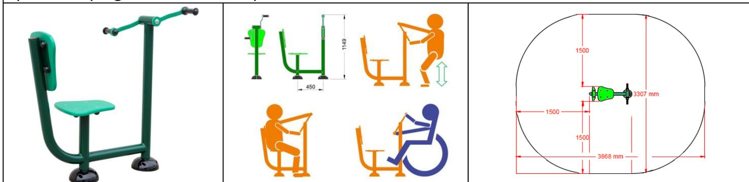
**Le médalier référence EN80266** est en acier revêtu d'une couche d'apprêt + peinture époxy cuite au four. Coloris standard vert foncé et vert clair (RAL 6005 et 6018) ou gris foncé et gris clair (RAL 9006 et 9007). Axes galvanisés, roulements étanches. Sièges en stratifié (HDPE). Pour un usage debout accompagné la rotation par une flexion des genoux quand les poignées arrivent en position basse. Conforme à la norme NF EN 16630.
